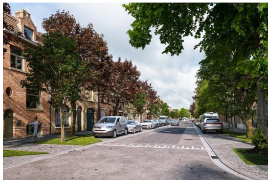
Referentie Karel De Stoutelaan, Brugge: fietsstroken in comfortabele verharding, resterende middenstrook in kasseien om het verkeer te vertragen en fietsers visueel voorrang te geven.
