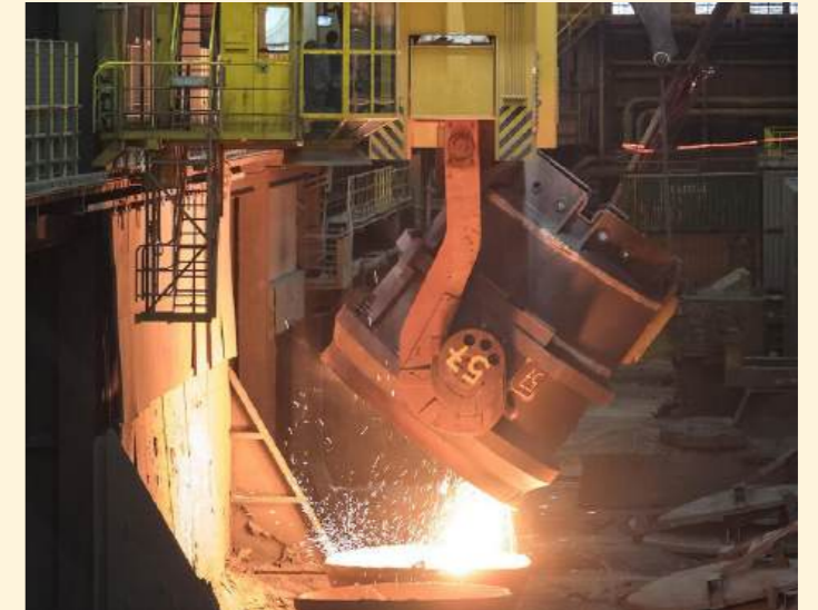
3. Kwaliteitsbewerking: Middels zuurstofovens wordt het ruwijzer gezuiverd en omgezet in ruwstaal.
