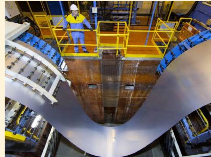
5. Staalbewerking: Het staal wordt gewalst tot strippen en platen om vervolgens afgewerkt te worden middels galvanisering, vertinning, of polymering.
