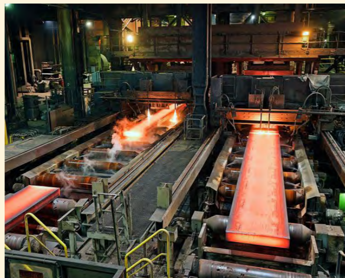
4. Staal productie: Het ruwstaal wordt in elementen gegoten voor nabewerking, of directe export.
